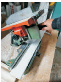
Per i tagli usare una troncatrice o normale sega da legno
