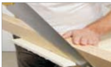
5 - Tagliare poi alla misura occorrente con sega a mano
